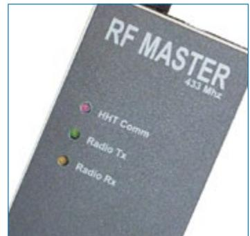
Fácil seguimiento de la comunicación con utilización de los tres leds
