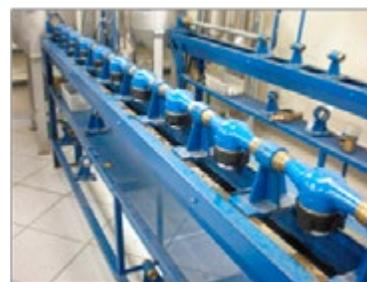
Figura 2 – Etapa para eliminación de aire del sistema
