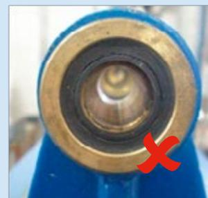
Sello plano: puede tener área reducida en el diámetro interno después del ajuste de los medidores en la mesa de trabajo.
