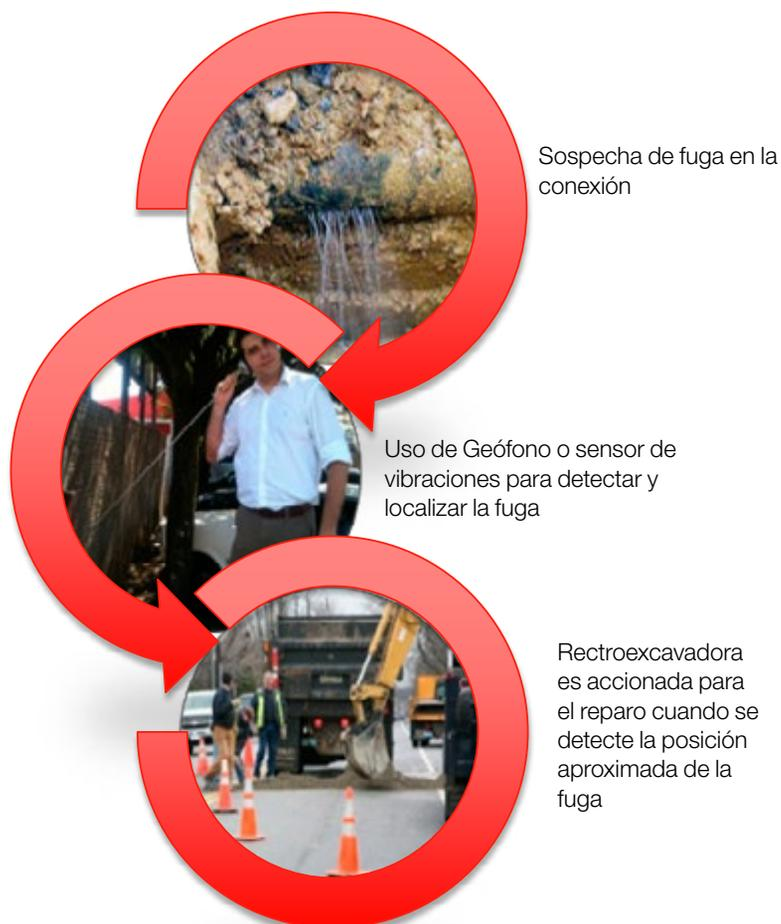
A través de la tecnología Itron, llamada M-Log, las concesionarias tienen un proceso de detección de fuga más eficaz en comparación a los métodos antiguos. El sensor M-Log cuando instalado a lo largo de la red de distribución, detecta un evento y a través del mlog Controller se recolectan las informaciones de monitoreo de estos sensores.
