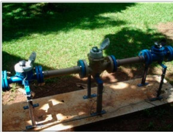
Figura 01: Instalación en serie
