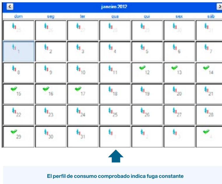
La Concesionaria "A" ha encontrado una conexión irregular de agua (by-pass), representado en el Gráfico 10, lo que justificaba la fuga constante según notificado por el sistema.
