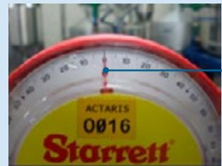
*Figura 4 – Medidores de agua verificados en lo referente a la inclinación.*
